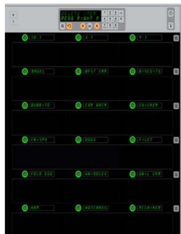
Armário com itens do menu apresentados. O item a ser eliminado é seleccionado através de uma tecla do temporizador. A eliminação é confirmada com a tecla OK no controlador.
